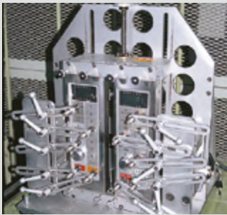
Uthållighetstest av kontrollpanel* 4 200 000 gånger användning av pekplattor
