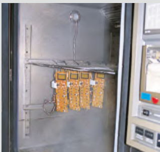
Stresstest för kretskort* 4 Temperatur -40 °C till +85 °C, relativ fuktighet 85 %
