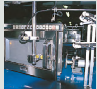
Uthållighetstest av lucka (öppning och stängning)* 4 öppna och stänga luckan 400 000 gånger
