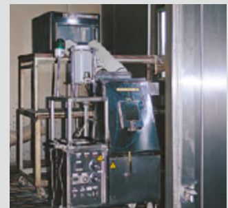
Damm- och ångtest* 4 Drift i damm och ånga vid en temperatur på 40 °C och en relativ fuktighet på 95 %
