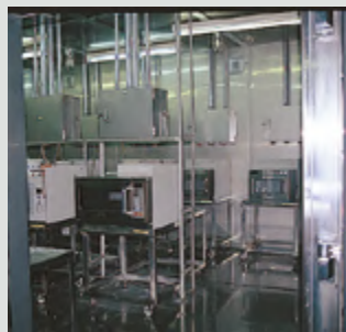
Kombinerad stresstest* 4 Temperatur 0 °C till 40 °C, relativ fuktighet 85 %
